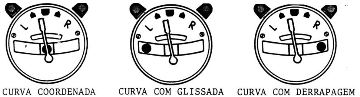
Figura 2-85 Indicações de um inclinômetro em situações distintas de vôo.
